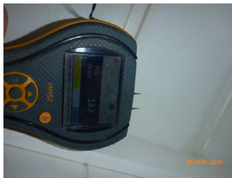
Fuktsøk i himling, ingen avvik i ledeevne
